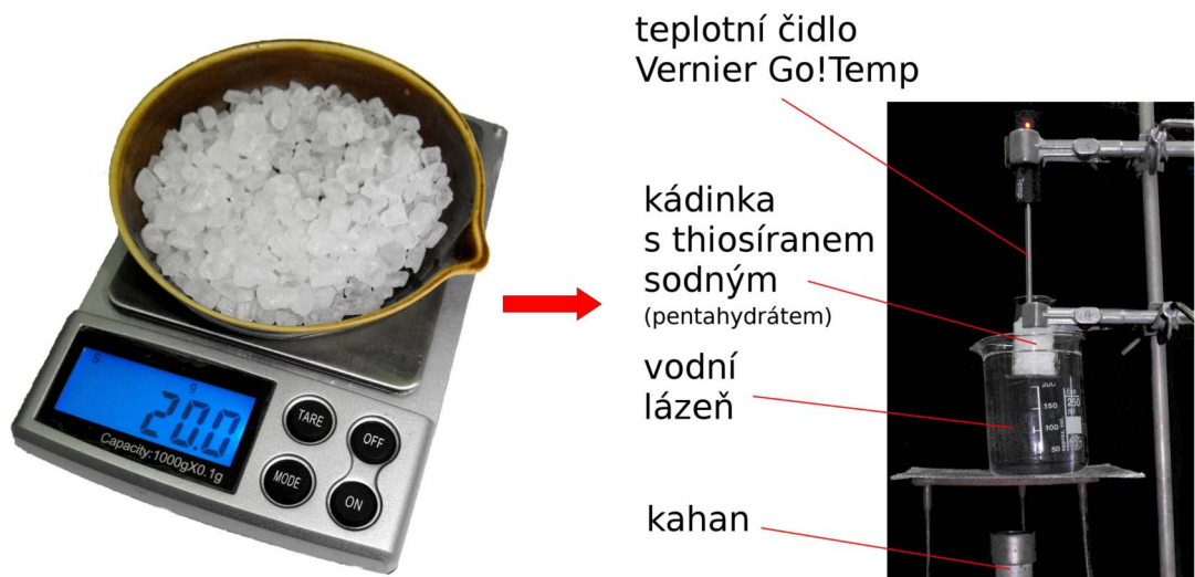
Obrázek 5.44: Vážení pentahydrátu thiosíranu sodného, uspořádání při měření
