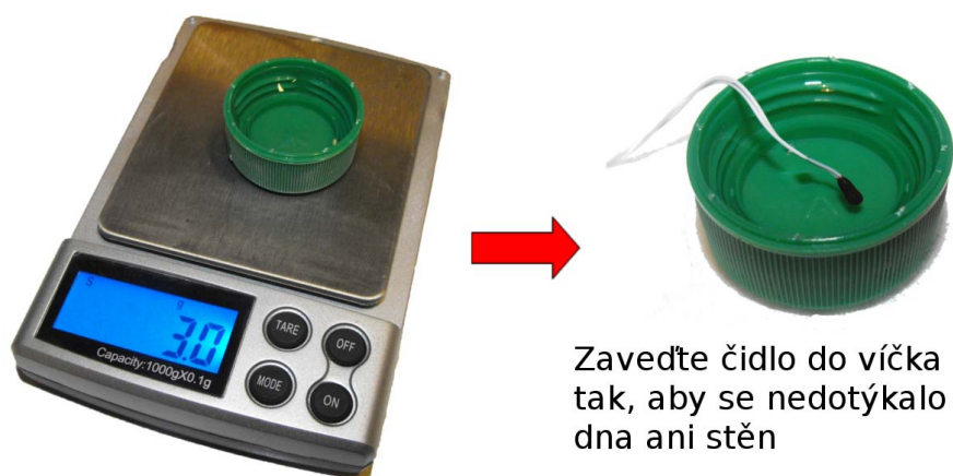
Obrázek 5.49: Vážení vody ve víčku, zavedení teplotního čidla do vody
