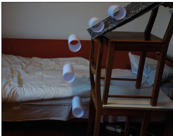
Obr. 3: demonstrace Magnusova jevu
