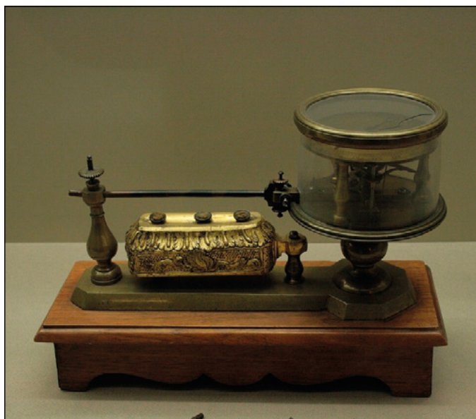
Obrázek 1. Pokus na délkovou roztažnost kovů [4]
