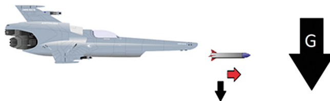
Obrázek 6. Vztažná soustava plavidel v tíhovém poli Země. Kromě rychlosti, se kterou se vzdaluje od lodi, nabírá nyní střela i rychlost, způsobenou tíhovým polem Země.
