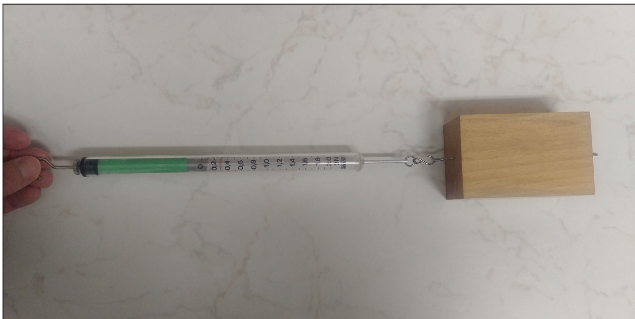
Obrázek 5: Měření velikosti třecí síly pomocí siloměru (zdroj: autorův archiv)
