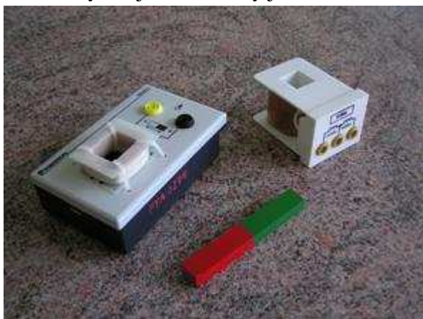
Obr. 6. Pomůcky k vzniku indukovaného napětí
