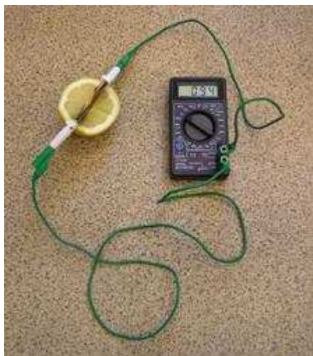
Obr. 1. Galvanický článěk z citronu
