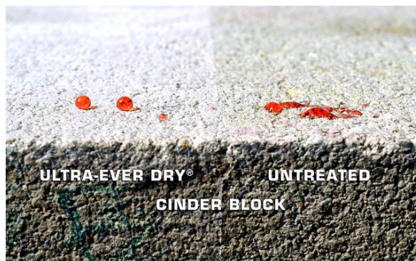
Obr. 7 Ošetření povrchu materiálů proti nasákavosti ( http://www.ultrananotech.cz/fotogalerie/ )
