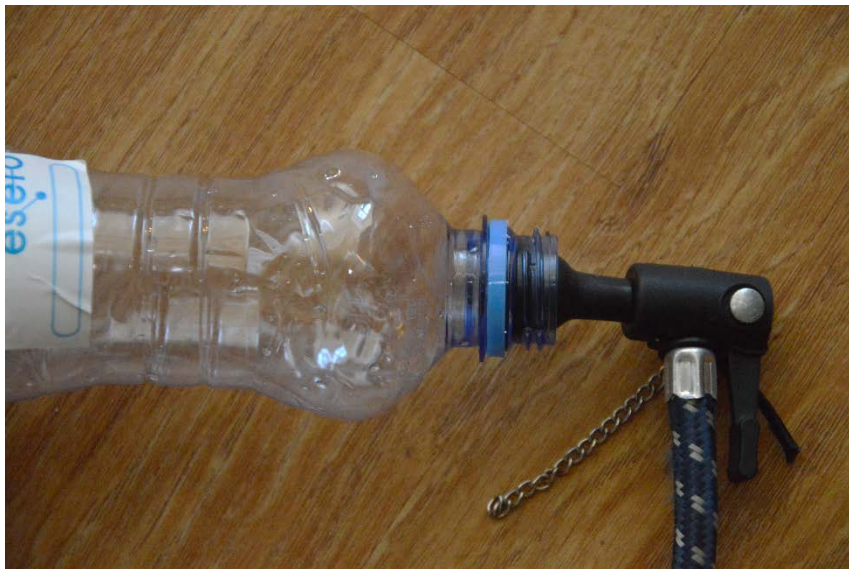
Obr. 2: Bezdušový ventilek TR415 v hrdle PET-lahve.
